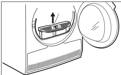
2. Öffnen Sie die Kondensatorabdeckung.
