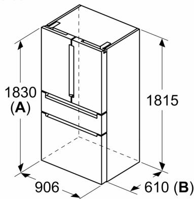
**A:** Front ist von 1830 bis 1847 mm, bei voll ausgezogenen vorderen Nivellierfüßen, verstellbar
