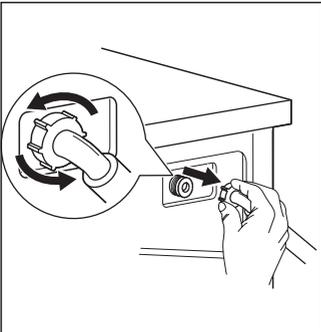
4. Reinigen Sie den Filter mit einer Bürste.
