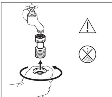
**Zum Schutz des Trinkwassers muss das beiliegende Rückschlagventil zwischen dem Wasserhahn und dem Wasserversorgungsschlauch installiert werden.** Dieses Ventil darf nicht am Gerät montiert werden. Stellen Sie den Schlauch richtig ein. Ziehen Sie die Ringmutter fest, um Leckagen zu vermeiden.
