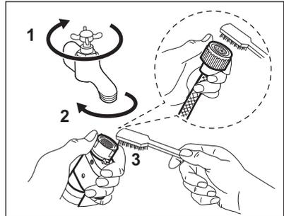
2. Lockern Sie die Ringmutter, um den Zulaufschlauch vom Gerät zu entfernen.
