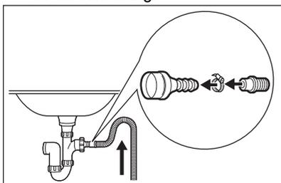
**i** Stellen Sie sicher, dass der Ablaufschlauch einen Bogen beschreibt, damit keine Partikel aus dem Becken in das Gerät gelangen können.
